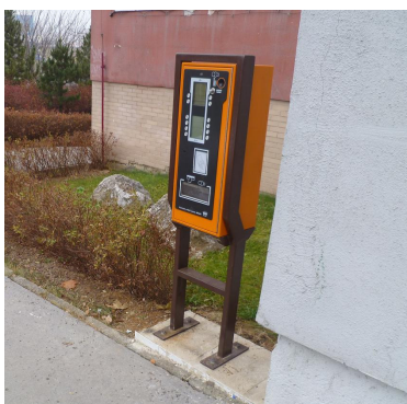
Obrázok 10 Osadený automat na cestovné lístky pri budove miestneho úradu
